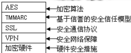
图 1 移动 Agent 的安全措施框架结构图
