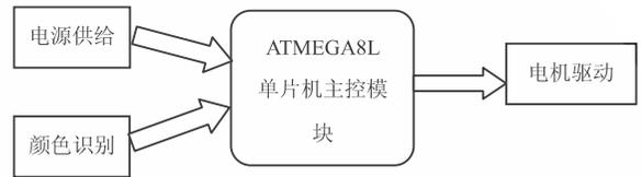
图 1 系统硬件结构框图
