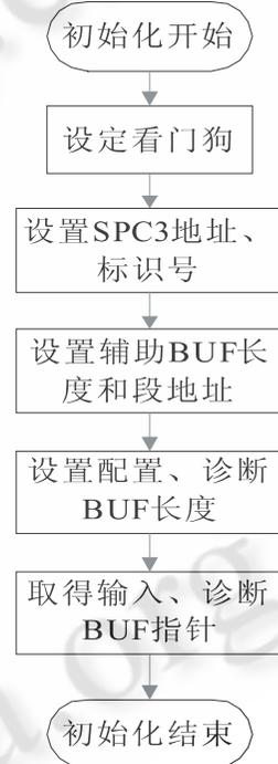
图 4 SPC3 协议芯片初始化流程图
