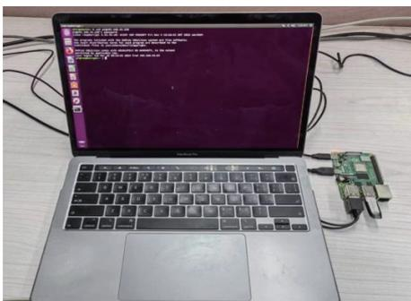
图 10 主机与物联网设备的本地网络连接实物图
