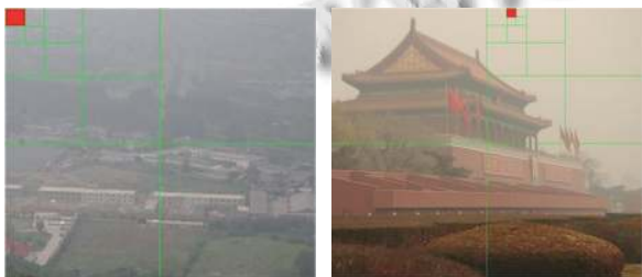
图 5 分层搜索方法选出的用于估计大气光值的区域
