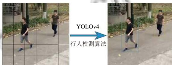
图2 YOLOv4目标检测示意图
