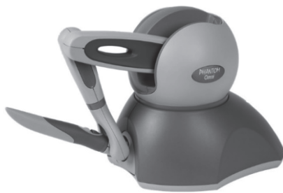
图4 Geomagic Touch 三自由度力觉交互设备
