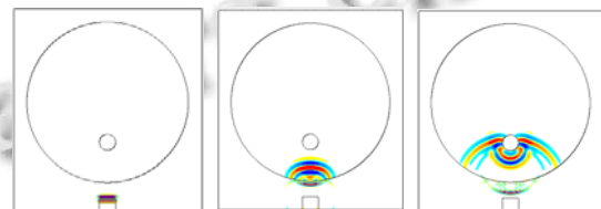
(a)探头发射超声波(b)下表面反射波(c)气孔反射波
