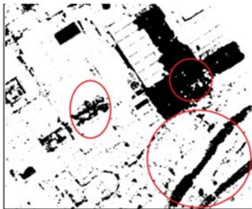
图 8 标准支持向量机方法生成的包含建筑损毁的地震区域变化检测映射图像
