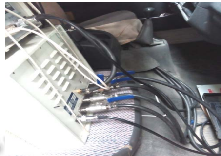
图 9 油耗传感器与汽车实际连接管路图
