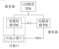
图 1 双层次细节渐进优化技术实现框架图
