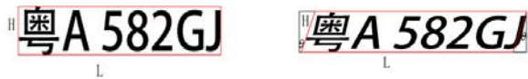
(a) 正常车牌区域面积 (b) 垂直倾斜车牌区域面积 图 6 车牌区域面积示意图
