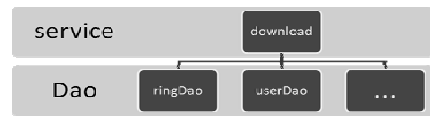
图 2 原多媒体彩铃逻辑流程分层图
