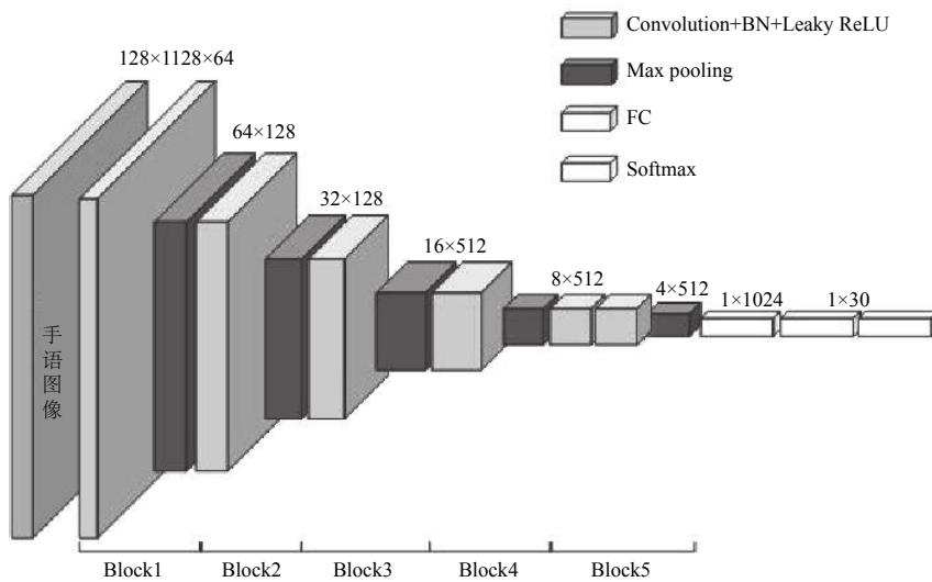
图4 改进的VGG网络结构图
