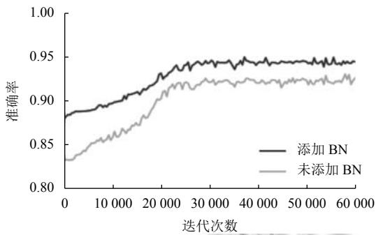
图12 准确率随迭代次数的变化曲线
