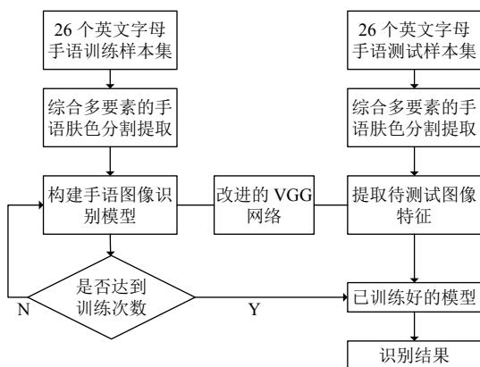
图 5 基于改进的 VGG 的手语识别方法流程图
