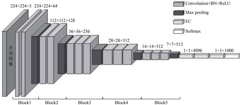
图 3 VGG 网络结构示意图
