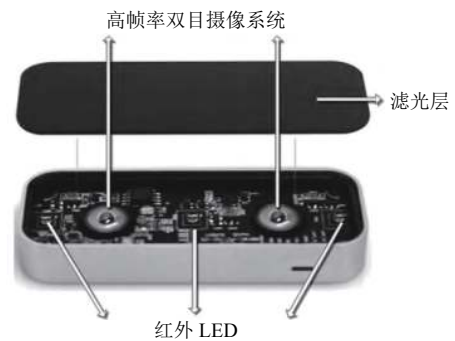
图1 Leap Motion 结构示意图
