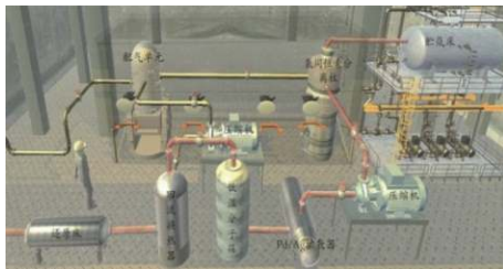
图7 正常工况下的 TES 系统三维虚拟场景图
