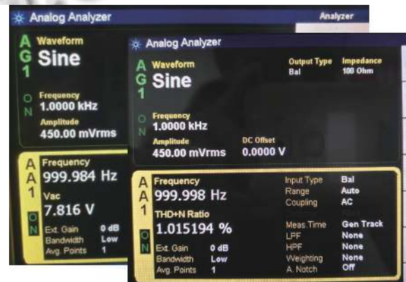
图 7 混音输出幅度和失真率测试结果截图示例
