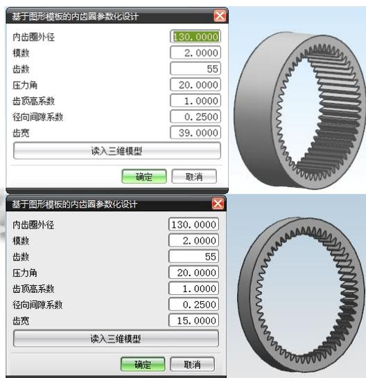
图 6 内齿圈参数化设计模型
