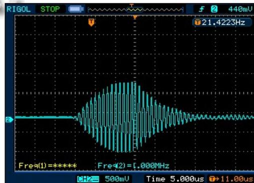
图 4 15 个脉冲接收波形
