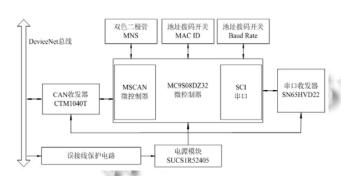
图 4 DeviceNet 现场总线协议转换器的硬件设计
