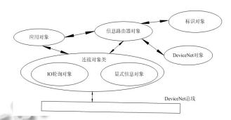
图 5 协议转换器的对象模型
