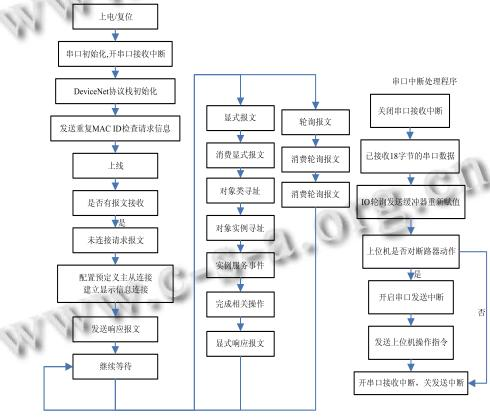
图 7 DeviceNet 协议栈软件流程图
