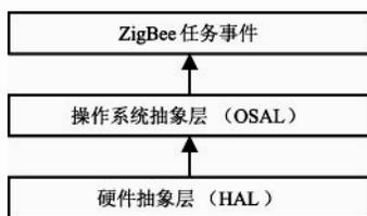
图 2 Z-Stack 协议栈总体框架
