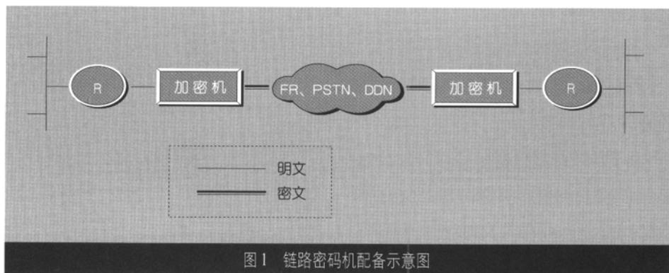
图 1 链路密码机配备示意图
