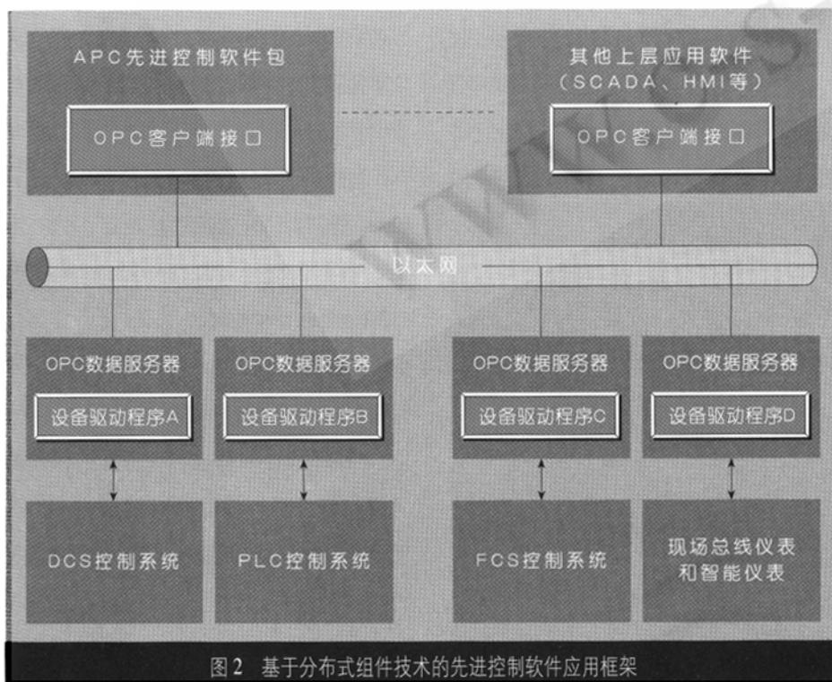
图2 基于分布式组件技术的先进控制软件应用框架
