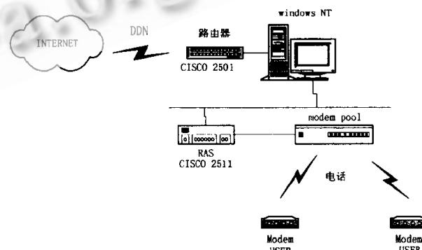
CISCO 2501 路由器的 WAN 口连接 INTERNET,以太网口连接本地子网,采用静态路由协议。NT 服务器的 3C509 网卡连接到这个子网上,使得 NT 服务器与 INTERNET 连通。NT 服务器的另一个网卡 NE 2000 连
