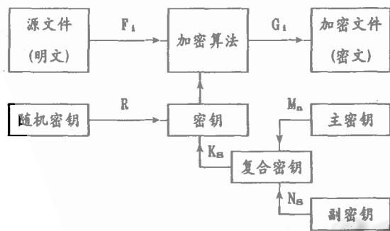
图 1 加密器的加密工作原理
