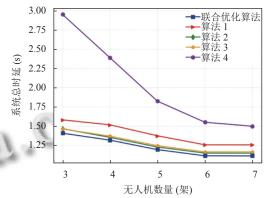
图 6 不同方案下系统总时延随无人机数量变化情况
