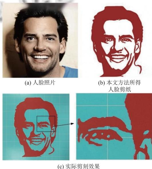
图 16 利用自动切割对所得人脸剪纸进行雕刻
