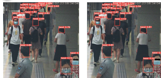
(a) YOLOv5s 检测结果 (b) 剪枝 MCA-YOLOv5s 检测结果
