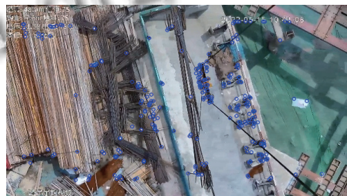
图 1 经典 ORB 算法特征点提取结果
