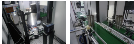
图 6 汽车气缸套生产线及数据采集系统
