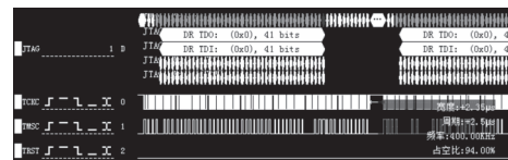
图 7 Morpheus 调试协议栈总线访问时序图
