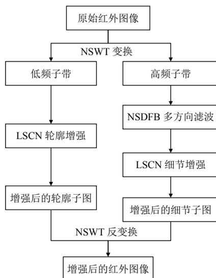
图 2 不可分离小波多尺度变换的红外图像增强算法
