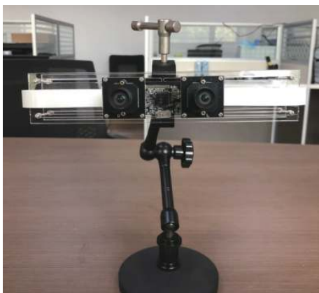
图1 油茶果的双目视觉识别系统模型
