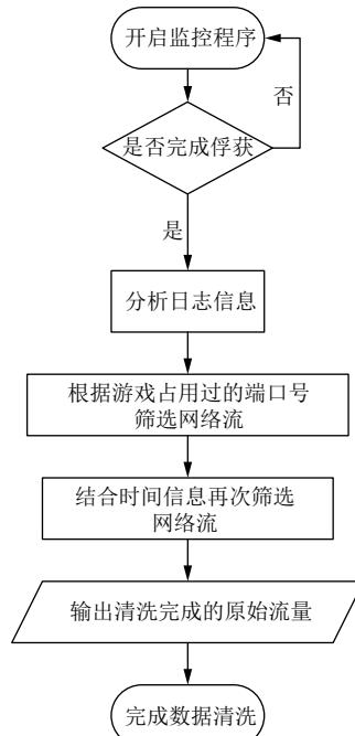
图1 数据清洗流程图
