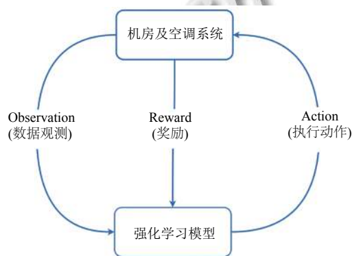
图1 强化学习在机房空调节能控制中的原理
