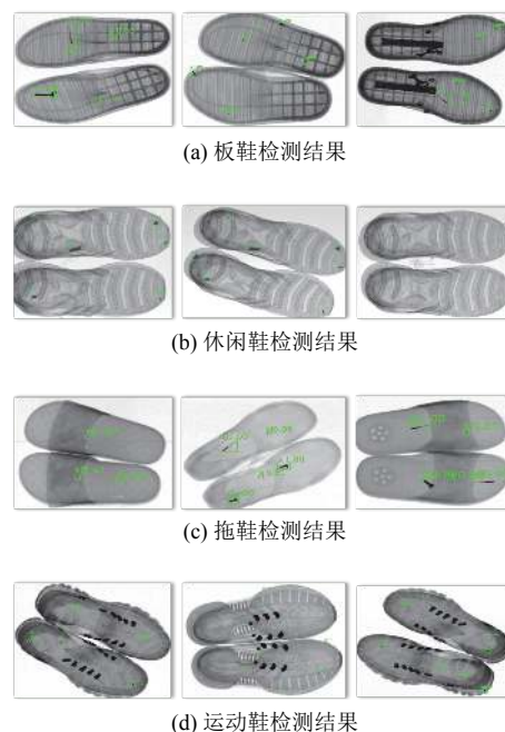
图13 不同鞋底异物检测结果(包含钢珠、断针、铁钉等)
