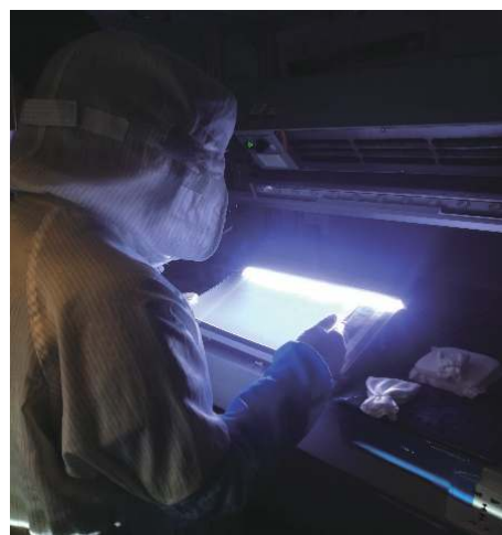
图 1 人工检测导光板缺陷实拍图
