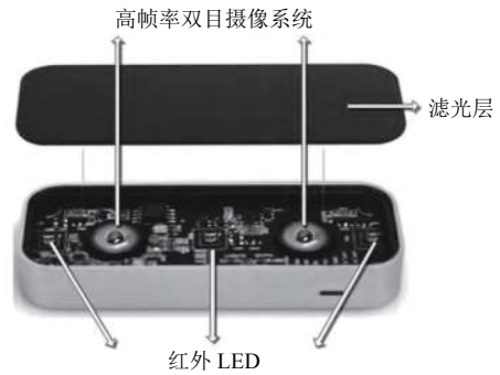
图1 Leap Motion 结构示意图
