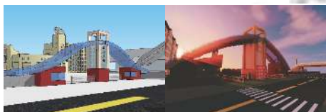
图 6 多边形模型和转化后的对应体素模型
