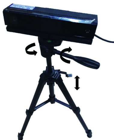
图4 安装三脚架后的 Kinect 二代体感器
