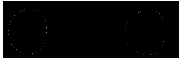
图 3 边缘提取后的双目视觉图像
