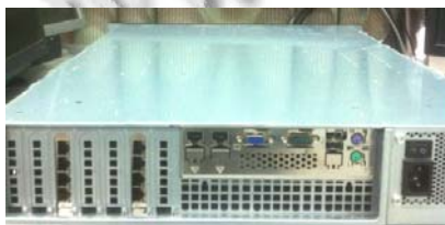
图 4 安装 POF 交换机的 10 网口主机
