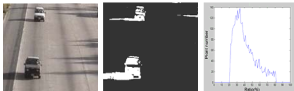
(a) 前景帧 (b) 运动目标二值图 (c) 亮度比直方图 图 1 疑似阴影点亮度比直方图
