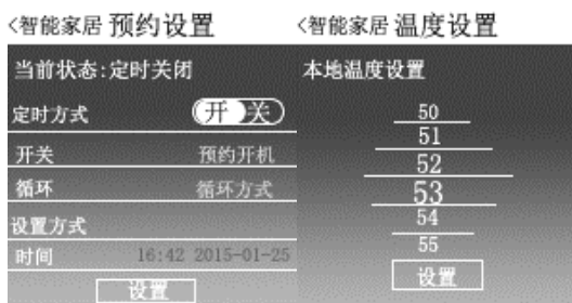
图 6 采暖温度设置界面和预约设置界面
