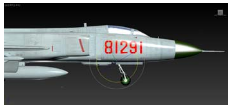
图 6 3dsMax 中设置前起落架的 DOF
