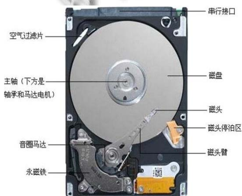
图 4 机械硬盘内部结构
