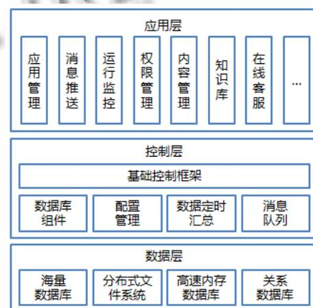
图 6 企业移动运维平台服务端架构
