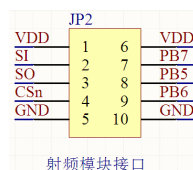
图 10 射频模块接口电路
