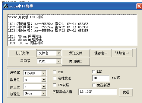
图 7 SCOM 串口助手显示设置指令返回状态
