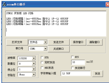
图 6 SCOM 串口助手设置闪烁间隔时间等待状态
