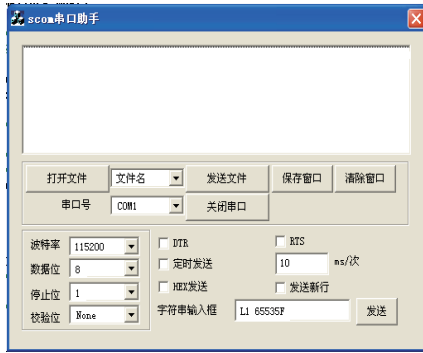
图 5 SCOM 串口助手初始化设置
