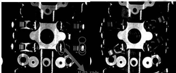
(a) (b) 图 8 安装位置正确和错误的气门摇臂
